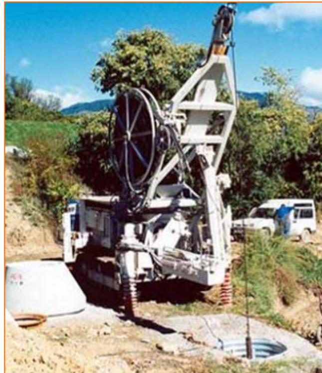
*Elementos exteriores del equipo de perforación de subdrenes*
